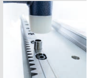
Golpeo del casquillo hasta introducirlo completamente
