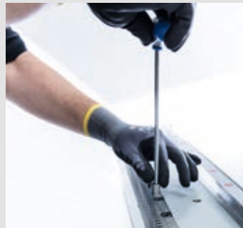
Montaje del casquillo del pasador. Girar en sentidos contrarios hasta que encajen y el casquillo pueda introducirse con la mano hasta la marca prevista
